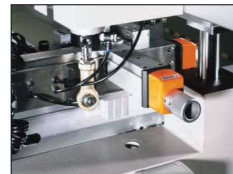
mikrometrische Siebfeineinstellung, analog ablesbar mit pneumatischer Verriegelung
