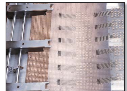
modernes Greifersystem mit programmierbaren Zeiten und automatischer Anpassung der Greifer bei verschiedenen Materialstärken
